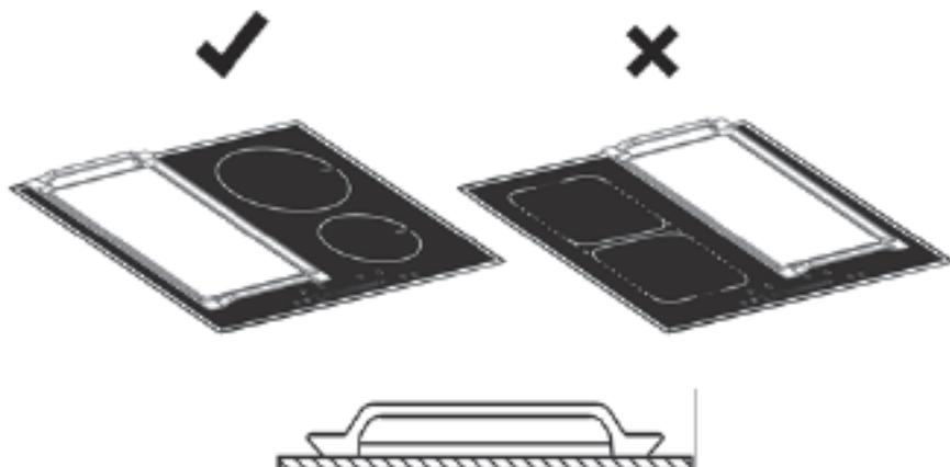
Jeśli używasz tacy grillowej, upewnij się, że podstawa dokładnie przylega do powierzchni płyty indukcyjnej.
